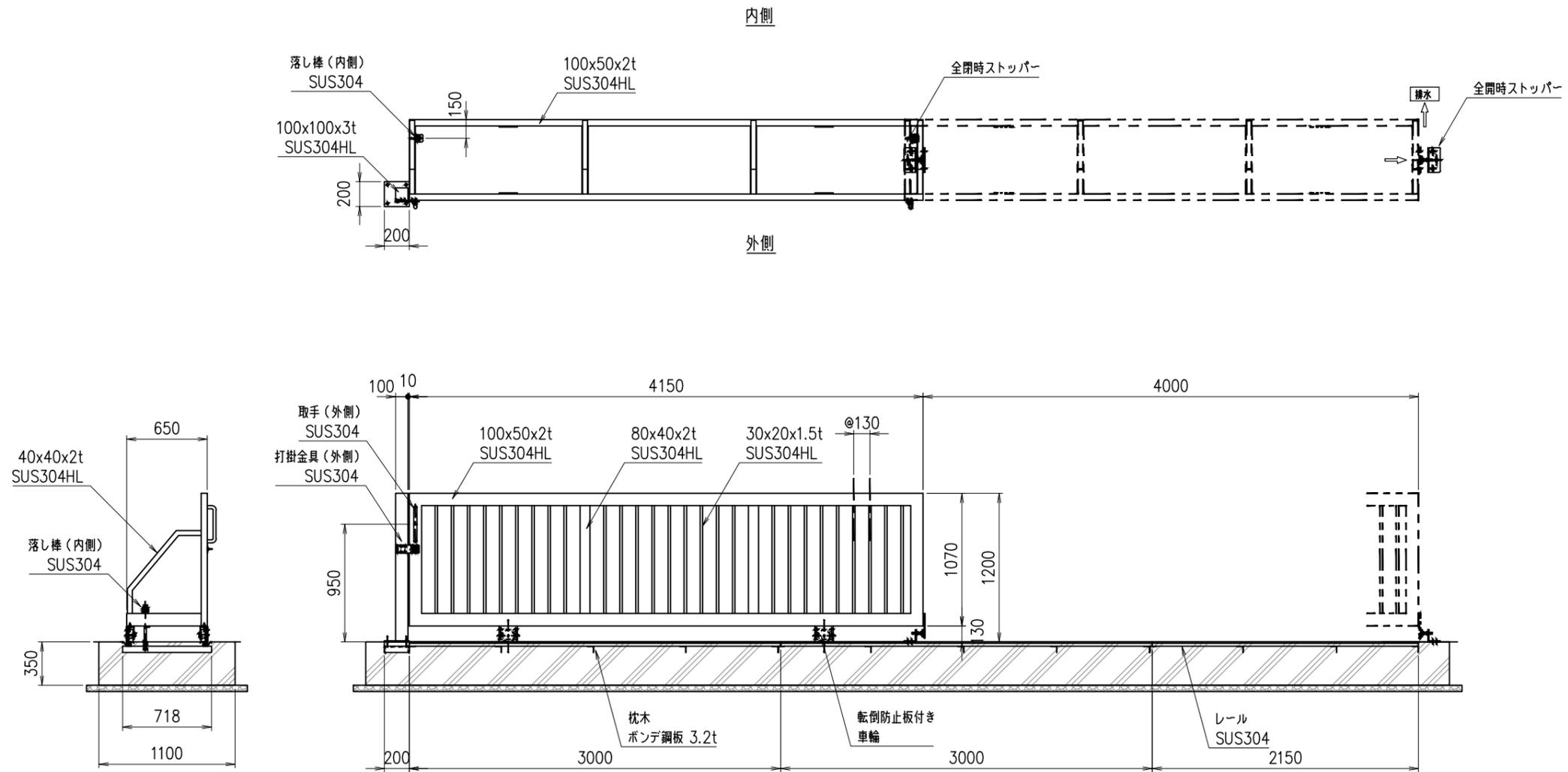
※ 図中の基礎部分に関しては、参考寸法・仕様としておりますので、環境により適切に設定してください。
